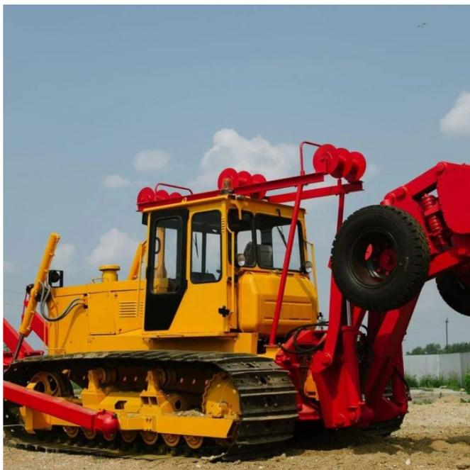
Совместно с кабелеукладочным оборудованием на базовый трактор устанавливается механический ходоуменьшитель, позволяющий вести прокладку кабеля со скоростью 0,4 – 2,5 км/час.
