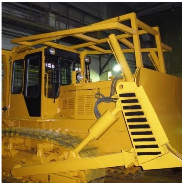
**ROPS (Roll Over Protective Structure)** — система структурных элементов, предназначенная для уменьшения риска нанесения повреждений оператору в случае опрокидывания управляемой им машины.
