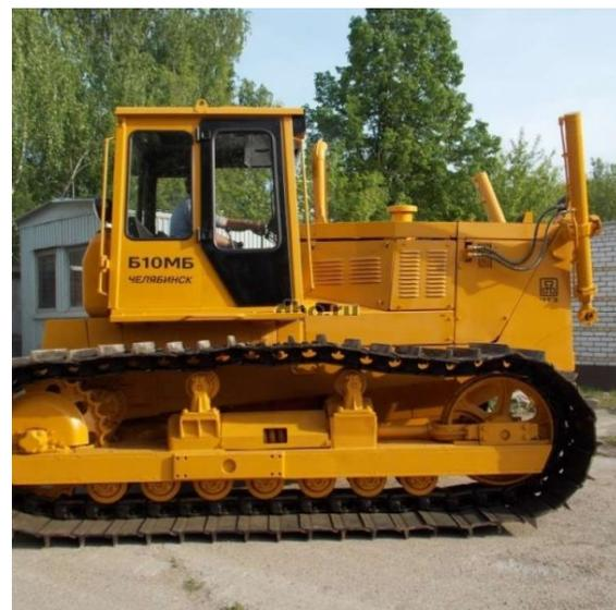
Трактор может эксплуатироваться в районах с умеренным и холодным климатом с обеспечением его работоспособности при температурах окружающего воздуха до минус 50 °С и, при соответствующем исполнении, в районах с тропическим климатом.
