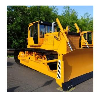
Бульдозер может эксплуатироваться в условиях умеренного и холодного климата при температурах окружающего воздуха от плюс 40 до минус 50° С, при высокой запыленности, а также в условиях тропического климата (тропическое исполнение).
