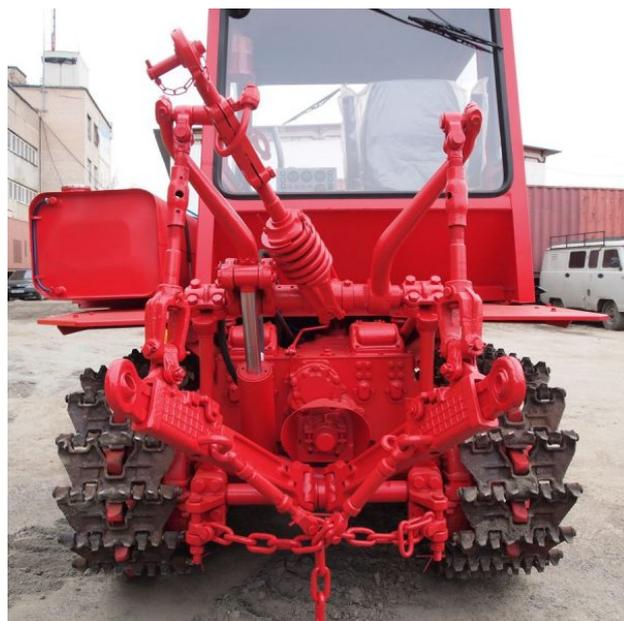
Навесные агрегаты соединяются с трактором в трех точках задних шарниров тяг. Это дает определенные преимущества в работе ГНС:
