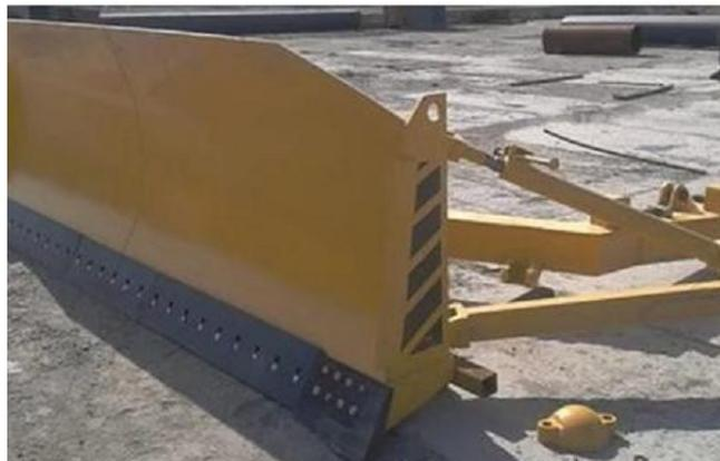
Поворотный отвал может поворачиваться в плане вокруг шарнира на раме в обе стороны. По форме это прямой отвал без боковых щек, удлинённый по ширине и укороченный по высоте.
