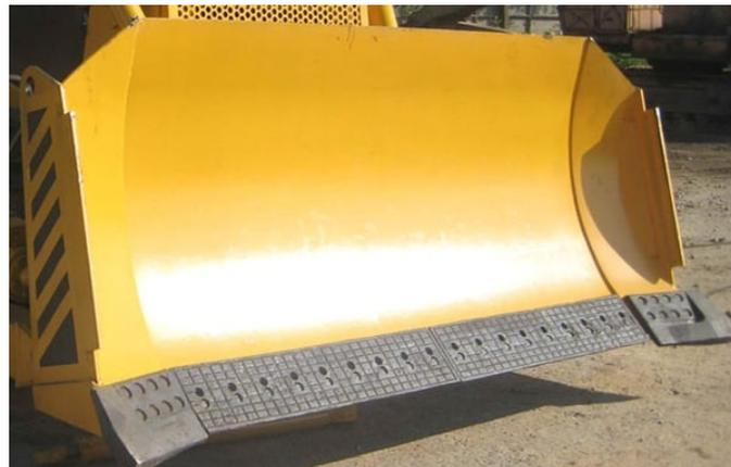
Более высокая производительность при разработке грунта по сравнению с прямым отвалом.
