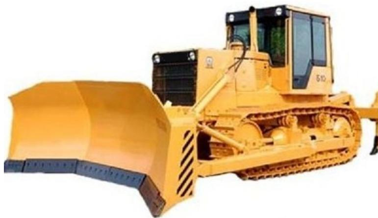
Он состоит из трех секций: центральной и двух боковых. Последние расположены под углом в плане до 25° к центральной секции. Изогнутая в плане форма отвала обеспечивает смещение грунта к середине отвала, обеспечивая при транспортировании минимальные потери материала.
